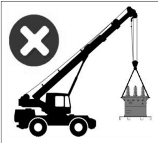
Figura 8: Prohibido transportar el transformador de las orejas de levante
