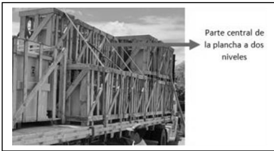
Figura 24: Dos niveles en la parte central de la plancha, nivelación carga.
