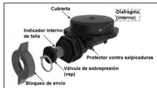
Figura 41: Partes del IFD
