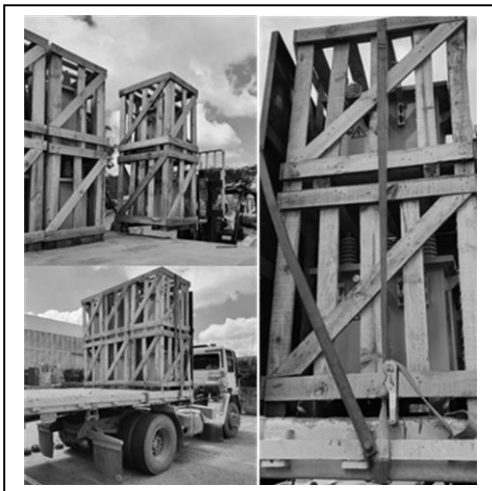
Figura 21: Cargue y aseguramiento de la primera fila
