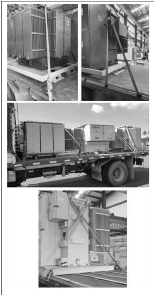
Figura 22: Algunas formas para asegurar la carga
