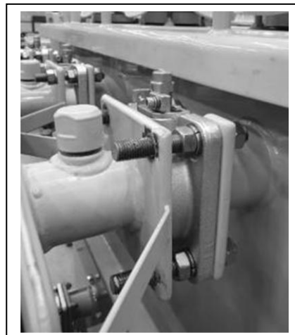
Figura 39: Desajustar y retirar tuercas
