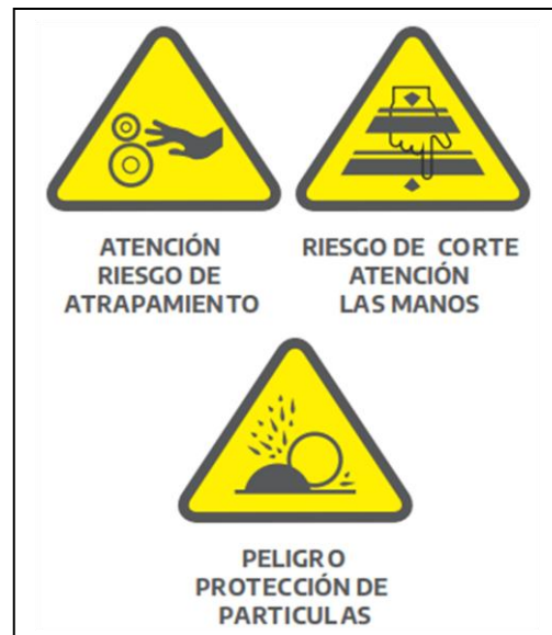
Figura 2: Señales de riesgo mecánico
