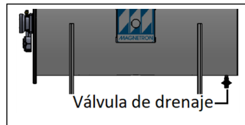
Figura 43: Válvula drenaje tanque conservador (de expansión)
