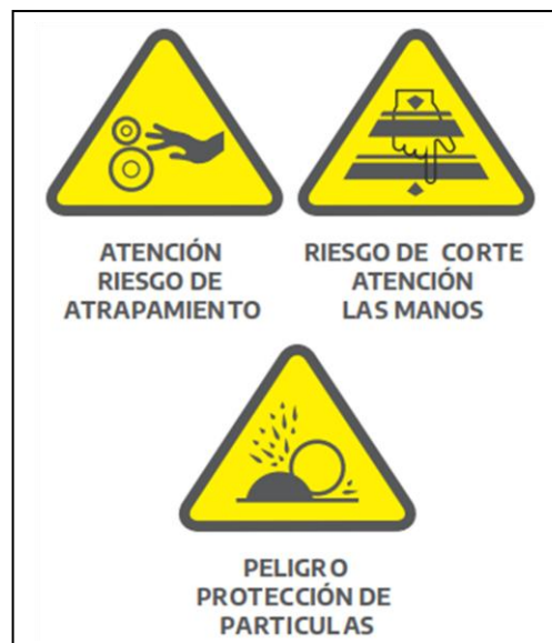
Figura 2: Señales de riesgo mecánico
